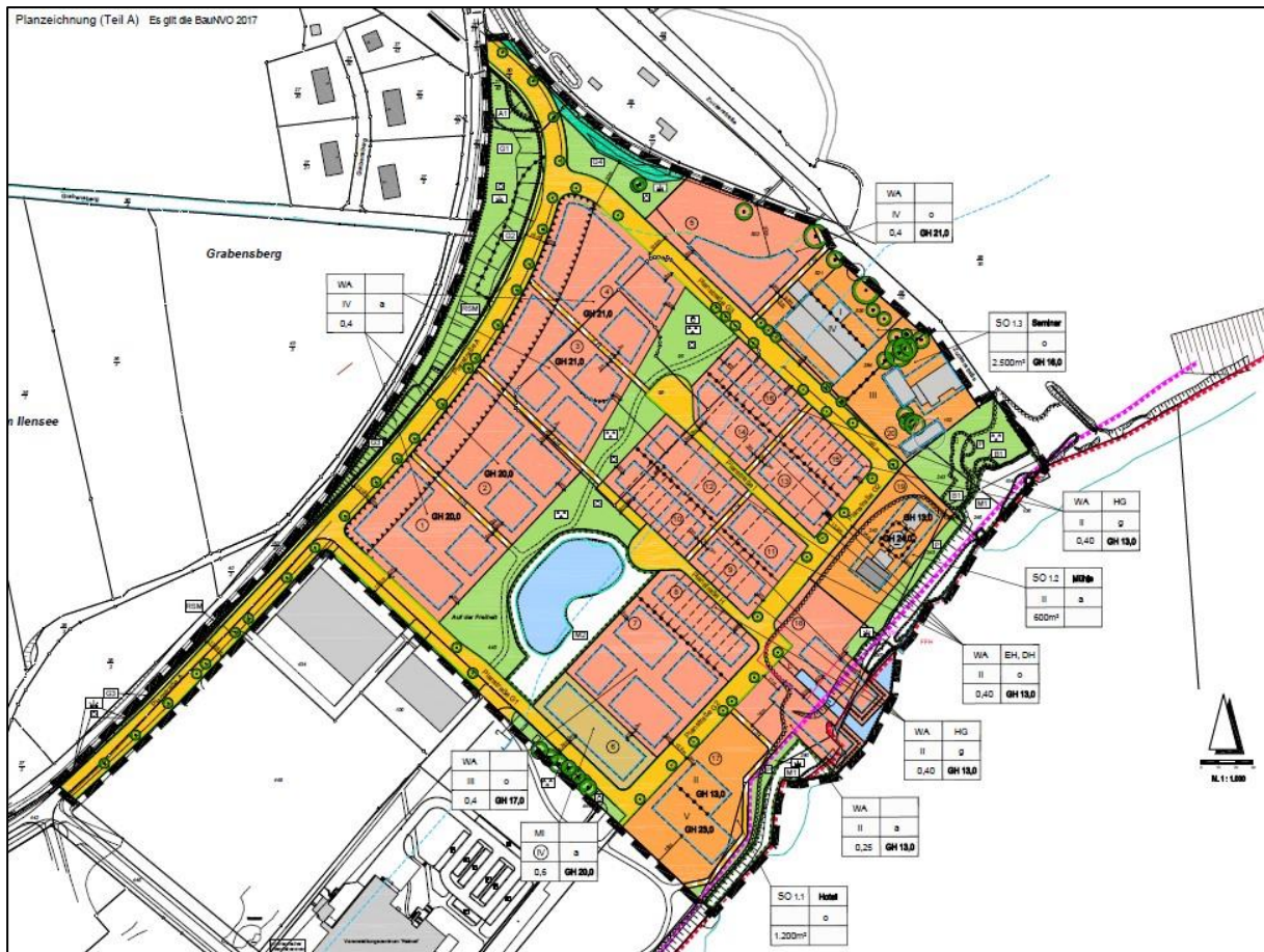
Abbildung 4: Auszug der Planzeichnung zum B-Plan Nr. 105 „Auf der Freiheit – Ostteil“ (Stand 30.04.2021).
